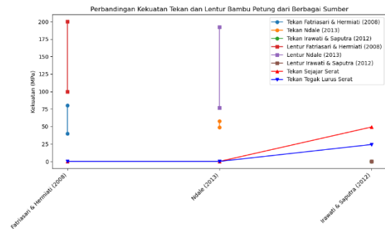
Gambar 2 Perbandingan kekuatan tekan dan lentur bambu petung dari berbagai sumber
